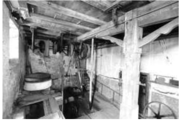
Abb. 63 24.5.2006; Teile der ehemaligen Mühle- einrichtung; Transmissionseinrichtungen für den Metzgereibetrieb um 1890
